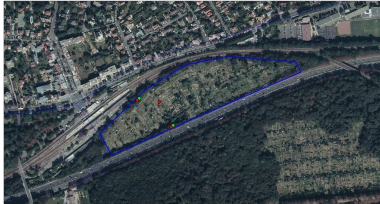
Figure 6 : Positionnement des sonomètres au sein du jardin. En rouge, les sonomètres SIP utilisés pour la mesure du niveau sonore. En vert, les sonomètres B&K utilisés pour la prise de son.
