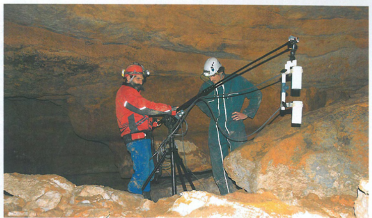
Figure 10 : Protocole de la prospection magnétique 3D utilisé à la grotte des Fraux. En 2011 (a) : les capteurs (cylindres blancs) sont déplacés manuellement par l'opérateur de manière à couvrir l'espace aussi bien que possible. Le prisme 360°, intercalé entre les deux capteurs, permet la géolocalisation des mesures par un système de poursuite du réflecteur par une station totale (présente en arrière-plan sur la photographie). En 2012 (b) : les capteurs sont suspendus au bout d'une perche télescopique fixée à l'aide d'une rotule articulée sur un trépied. Ce dispositif permet une couverture spatiale plus régulière. Protocol of 3D magnetic prospection in the cave of Les Fraux. a: in 2011, sensors (white cylinders) were moved by the hand of the operator. The 360° prism reflector (located between the both sensors) allowed us to obtain a geolocalization of the measurements by the tracking method of the total station (in the back of the picture). b: In 2012, a better control of the space covered was obtained thanks to a device made-up with a telescopic pole fixed on a tripod.
