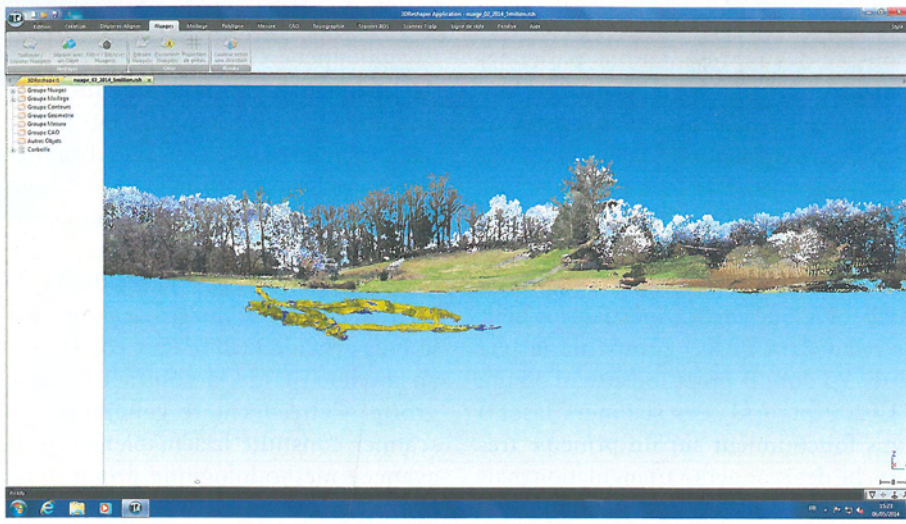
Figure 5 : Vue en perspective du modèle 3D global de la grotte, relié à la surface (vue d'écran prise sous 3D-Reshaper). Les données sont enregistrées dans le système de référence national. Perspective view of the global 3D-model of the underground network connected to outside (screenshot from 3D-Reshaper). Data are recorded in the French Geodetic Reference System.
