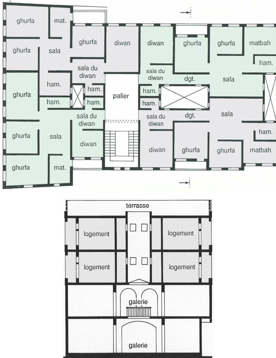
Figure 10. Un immeuble mixte à quatre appartements par étage
