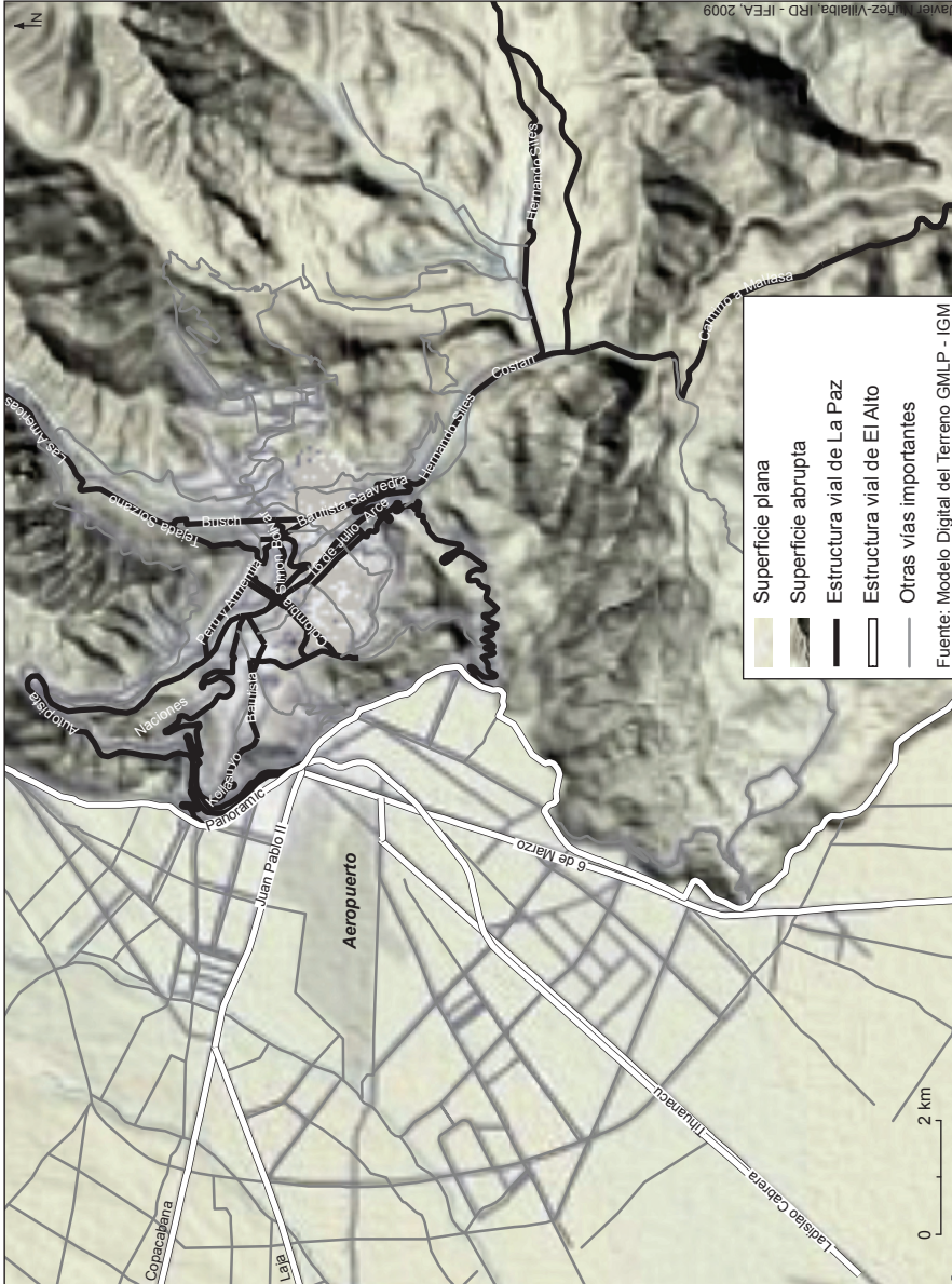
Figura 3 – Red vial principal de la metrópoli paceña (importante para las conexiones internas y el acceso a la metrópoli) y topografía
