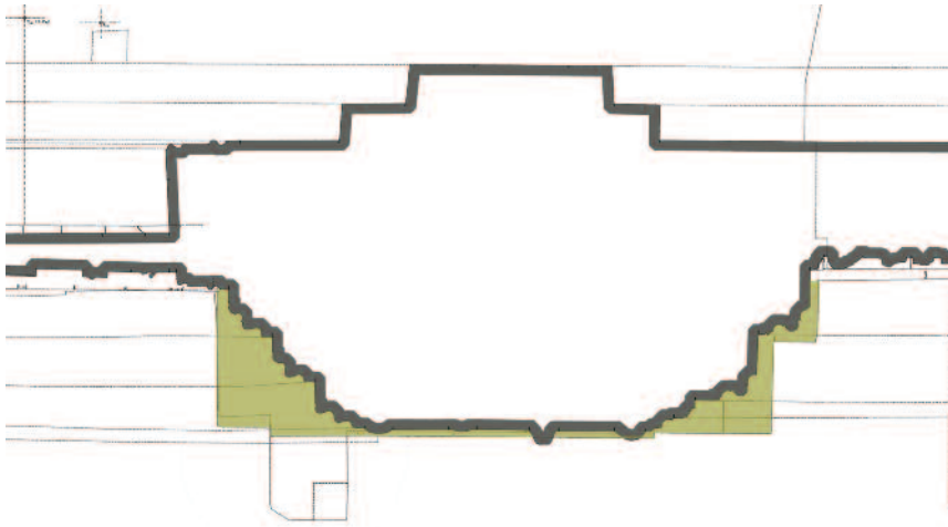
Fig.21 - Saint-Gilles-du-Gard, ancienne abbatale, façade occidentale. Détail du plan à hauteur des archivoltes entre le portail central et le portail latéral sud. Mise en évidence du désaccord entre la surface d'appui et les voussures (H. Hansen, 1999-2002).
