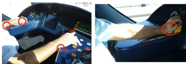
Illustration de la contrainte mécanique localisée avec le manipulateur linéaire.
