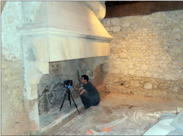
Photo 34 : Matthieu Gaultier en train de paramétrer le scanner laser au rez-de-chaussée du logis du prieur
