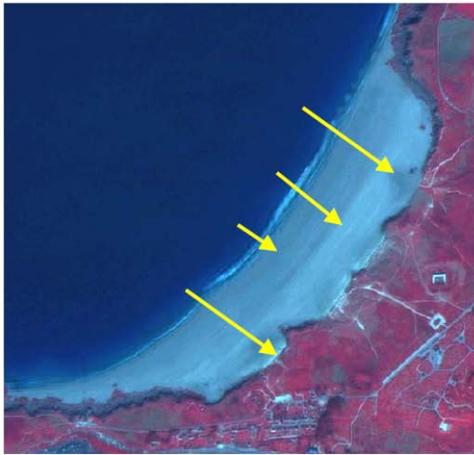
Ill. n°8 : Variations de la teneur en eau mise en évidence dans les sables de la plage des Blancs-Sablons par l'image Spot5.
