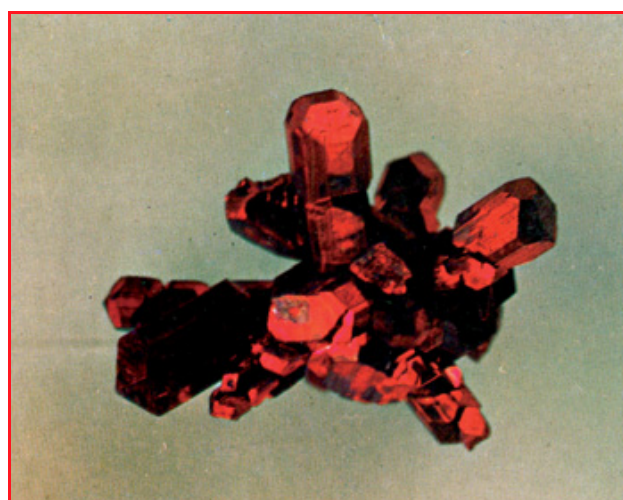
Cristaux du bronze oxygéné de tungstène Na_{0,60}WO_3 préparés par électrolyse de tungstate fondu.
