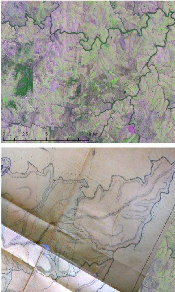
Figura 2 Detalle de la georreferenciación de un plano de agrimensura uruguayo
