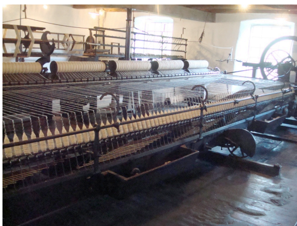
Mule Jenny, machine de filature du XIX e exposée aux Calquières, Langogne (Cliché : J.-B. Grison)
