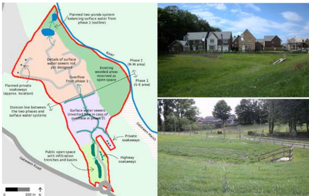
figure 22 : les systèmes de gestion des eaux pluviales du lotissement de Gatewen Road et photographies des bassins et tranchées d'infiltration et de rétention de la zone sud-est (en haut : partie amont ; en bas : partie aval)
