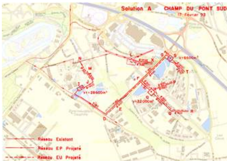
figure 17 : avant-projet sommaire du système d'assainissement du parc technologique établi par le Grand Lyon (Grand Lyon, 1993) 4
