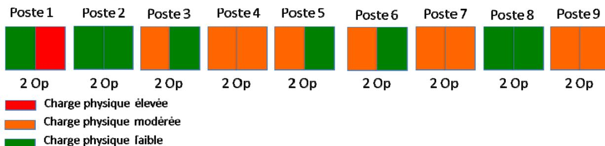
Dans le cadre de l'étude détaillée d'une chaîne d'assemblage d'automobiles composée de neuf postes doubles (assemblage en parallèle des éléments à installer à droite et gauche du véhicule), nous avons pu identifier comment, dans cette situation, se jouent les relations entre le vieillissement et la cotation des postes. Sur les neuf postes de la chaîne d'assemblage (cf. schéma ci-dessus), deux sont considérés à faible charge physique sur les deux critères d'effort et de charge posturale (postes
