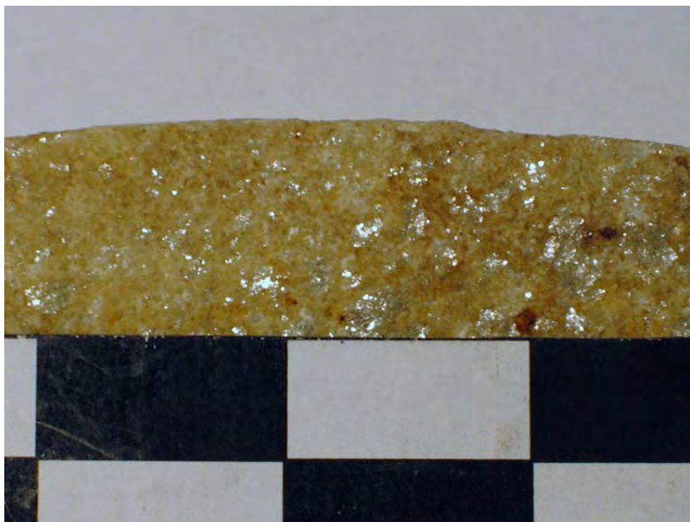
Figura 13: Detalle de un mármol homogéneo blanco sacaroideo con inclusiones micáceas (GUA-HL-08 UE12214-22).
