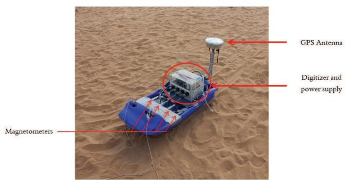
Figure 13: The «Sledge» device
