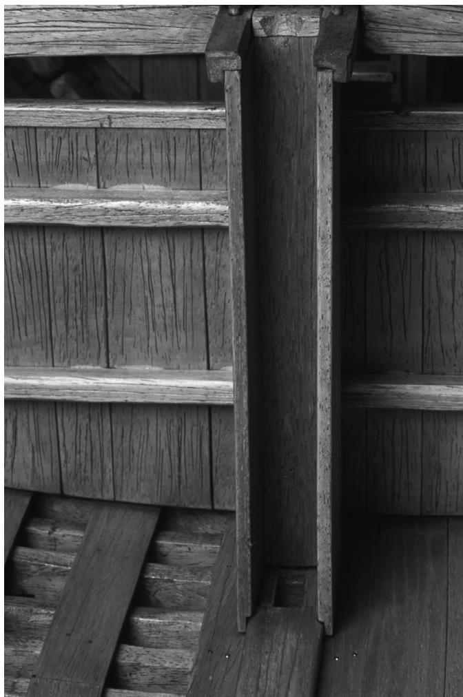
Fig. 5 : L'emplanture du mât avec son fourreau d'étambrai. Au fond, cloison de séparation entre la cale à dolia et la proue (photo L. Damelet, CCJ, CNRS, Aix-en-Provence).
