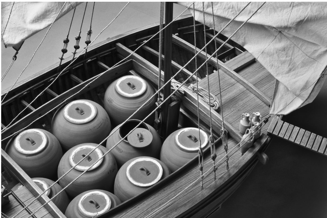
Fig. 9 : Vue de la cale à dolia et du pont. Noter la présence des surbaux (photo L. Damelet, CCJ, CNRS, Aix-en-Provence).
