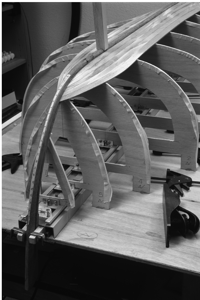
Fig. 3 : Construction de la maquette : mise en place du bordé (photo L. Damelet, CCJ, CNRS, Aix-en-Provence).
