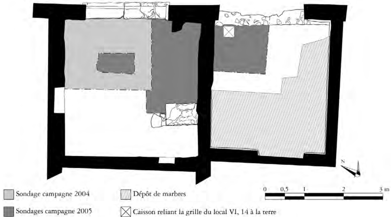
Fig. 50 – Herculaneum. Implantation des sondages en façade de la Casa del Salone Nero (Dessin N. Monteix d'après les relevés de O. Cerasuolo, V. Lallet et N. Palacios).
