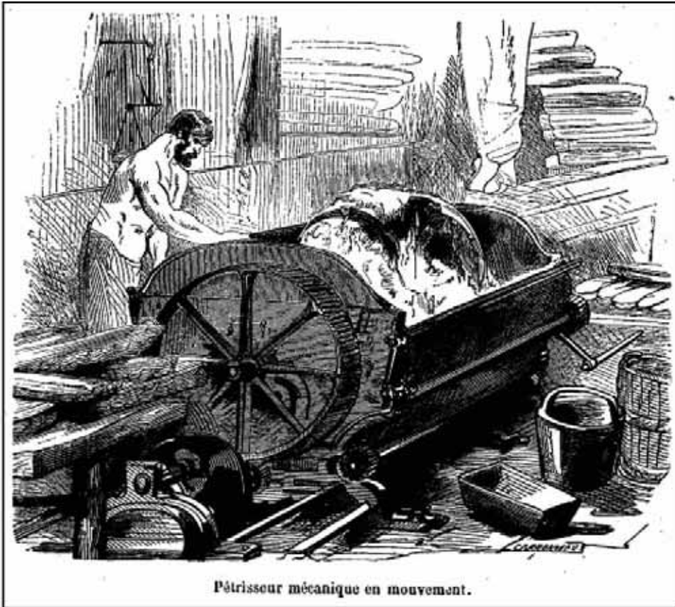
Figure 1. Le corps à distance : le pétrisseur mécanique en usage dans la boulangerie des hôpitaux de Paris sous le Second Empire (Julien Turgan, Les grandes usines..., op. cit., vol. 3, p. 117).
