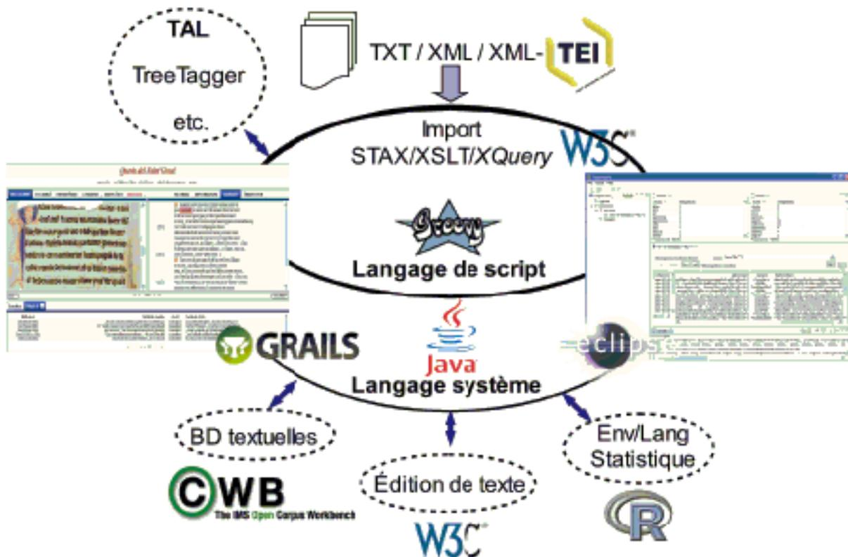
**Figure 1** : architecture de la plateforme TXM – la boîte à outils est cerclée en trait plein, les composants cerclés de pointillés sont des processus indépendants. La copie d'écran de gauche correspond à l'interface de l'application web développée en Grails, la copie d'écran de droite correspond à l'interface de l'application locale développée en Eclipse RCP.
