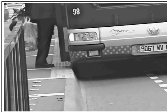
Photo 2 : Accostage en mode manuel d'un bus de la ligne « avec » guidage optique en panne à Clermont-Ferrand. Avril 2005.
