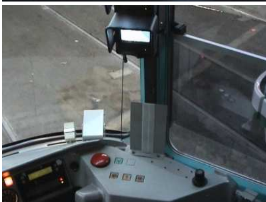
Dispositif de rétrovision sur les Saint-Étienne deuxième génération, avec caméras
