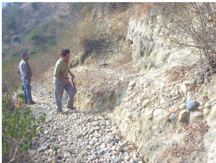
Formation de colluvions indurées sous les dépôts fins sablo-marneux
