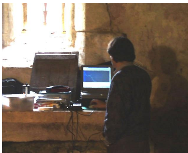
Figure 8 : mesure de la gammamétrie in situ de la chapelle du Boisset par l'équipe du CRPPA.
