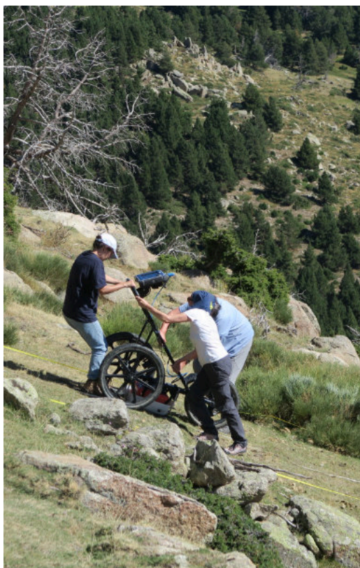
Fig. 113 - Acquisition du relevé au géoradar - Zone « G » 2 (Enveitg) (© Jean Pierre Calastrenc)
