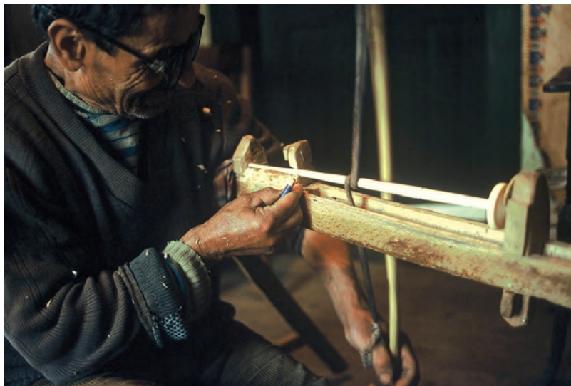
Fig. 246. Le tourneur de fuseaux Gheorghe Riob décore au crayon de bois de couleur un fuseau sur son tour à archet, Roumanie, Maramures, Botiza, 1994 (photo P. Mille).
