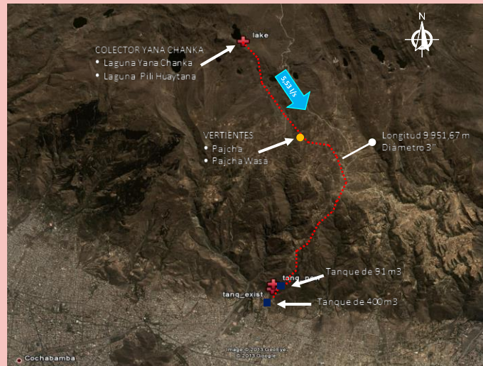
Figure 1: Adduction des sources et des lagunes
