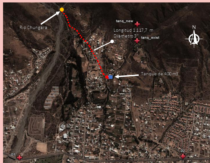
Figure 2: Adduction de la rivière Chungara
