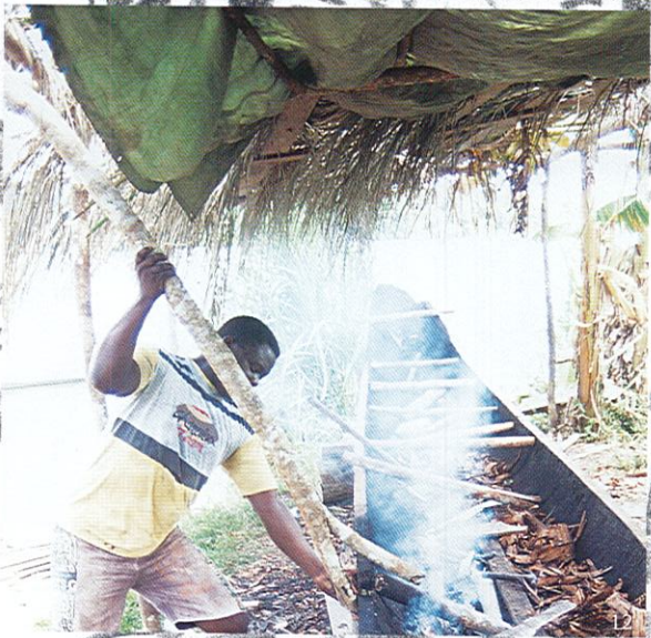
Mise en place des têtes de pirogue avant brûlage.
