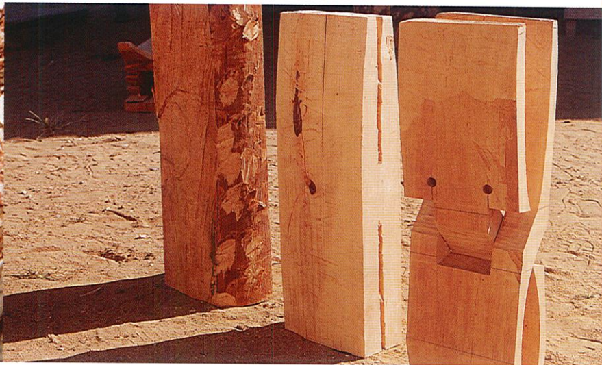
Esquisse et fabrication d'un banc pliant appelé Sati bocca bangi , fabriqué dans une seule pièce de bois.
