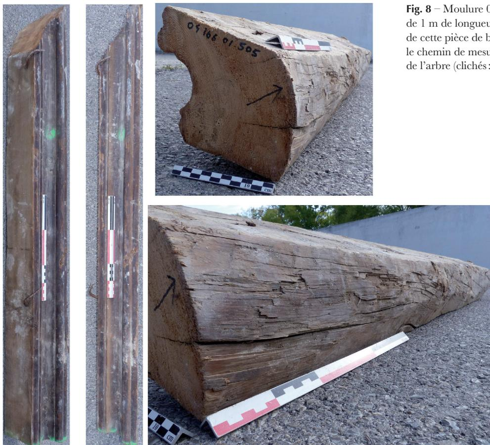
**Fig. 8** – Moulure 0416601\_505. Une section de 1 m de longueur a été prélevée. La face courbe de cette pièce de bois n'a pas été équarrie et le chemin de mesure atteint bien le dernier cerne de l'arbre (clichés: L. Shindo).
