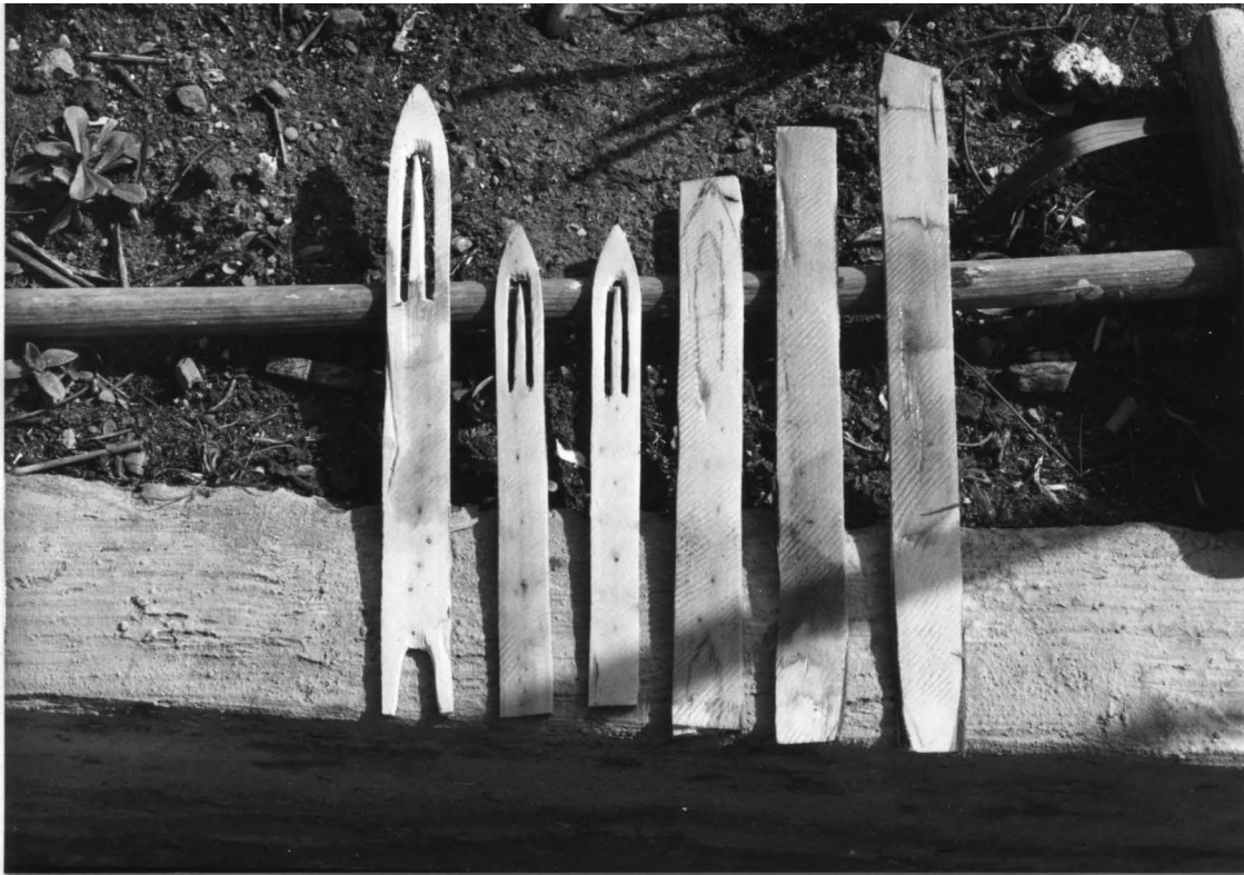
Aiguilles à différents stades de fabrication.
