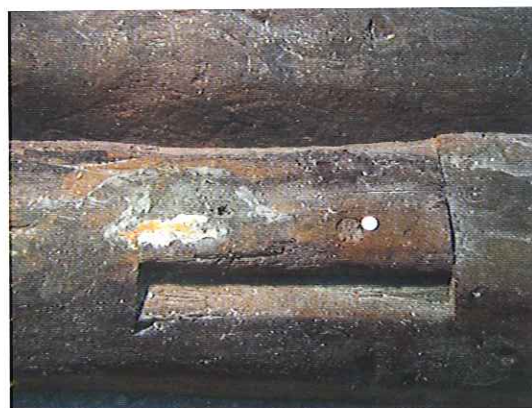
Fig. 14 : Vue de l'encoche d'encastrement des carlingots sur le dos d'une varangue. Photo : L. Brisciano.
