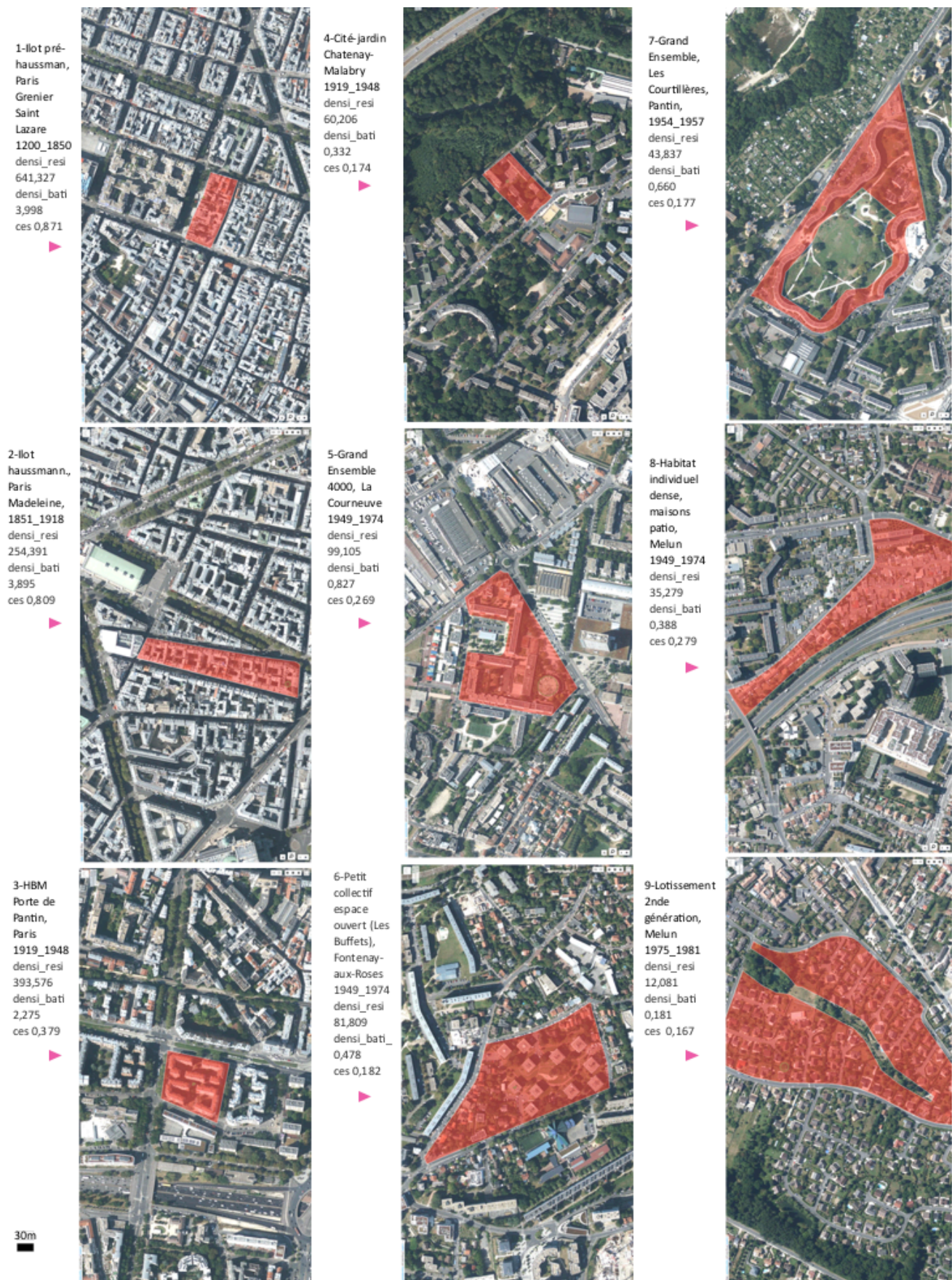
Fig. 4 : de haut en bas et de gauche à droite : différences de densités de neuf îlots caractéristiques du Grand Paris, classés par ordre historique et géographique (de Paris aux confins). La densité résidentielle (logements/ha), la densité bâtie et le coefficient d’emprise au sol (CES) sont issus de la base de données des IMU (îlots morphologiques urbains), IDG/IDF, 2021. Doc. Sabri Bendimérad, 23 janvier 2023.
