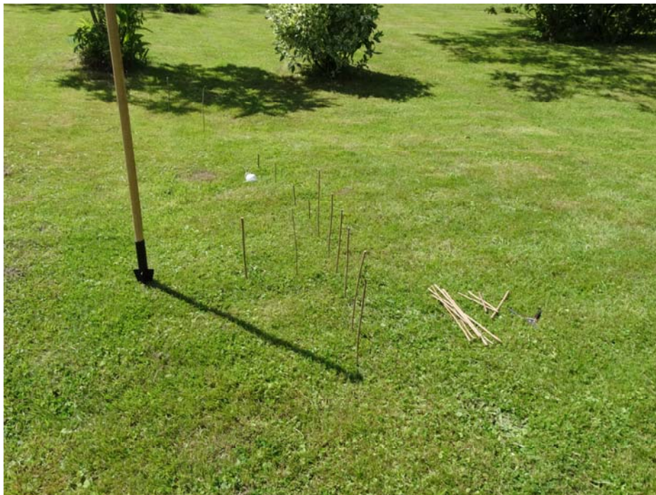
Fig. 20 – Le gnomon et les fiches plantées toutes les demi-heures (cliché G. Thébault).
