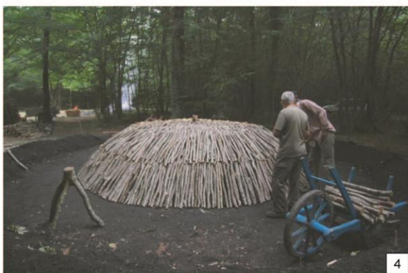
Charbonnière réalisée au mois d'août 2008 dans le Cher par l'association des "Charbouniers de Quincy" La meule contient environ 12 stères de bois. L'opération a duré six jours. (Photos : C. Bellanger et R. Rouaud)
