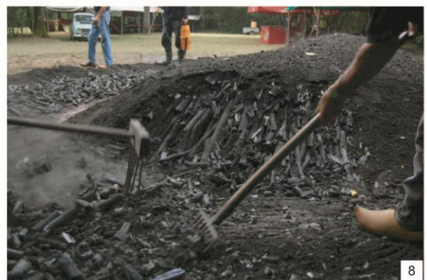
Charbonnière réalisée au mois d'août 2008 dans le Cher par l'association des "Charbouniers de Quincy" La meule contient environ 12 stères de bois. L'opération a duré six jours. (Photos : C. Bellanger et R. Rouaud)
