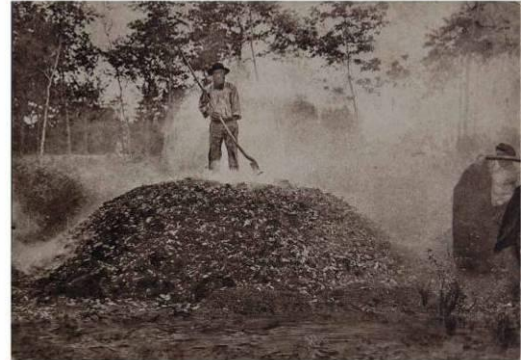
Deux cartes postales du métier de charbonnier au début du XXe siècle Au dessus : la meule en cours de montage Au dessous : la charbonnière en début de cuisson (Collection privée, Ch. Myszkiewicz)
