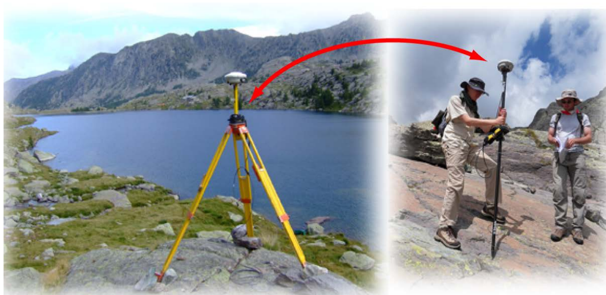
Fig. 2.5 : A droite , géolocalisation d'une roche gravée de la vallée des Merveilles, à l'aide d'un récepteur GPS mobile ; à gauche , station fixe en place à proximité du refuge destinée à améliorer la précision des relevés.
