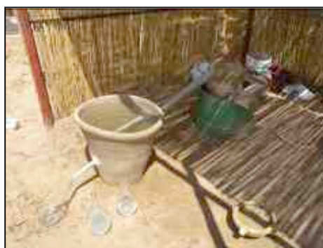
Photo 207 (gauche) – Alambic à feu nu, plaine de Grombalia Photo 208 (droite) – Extraction de l'eau de fleurs d'oranger avec un alambic à feu nu © 2010, RM
