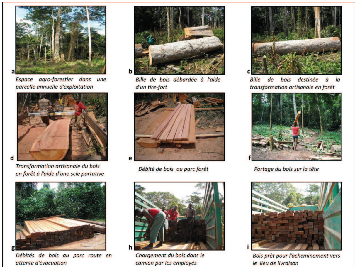
Photos 1 : Processus de transformation artisanale du bois dans les forêts communautaires de Morikoualiyé et de Mpewang. C. Kouna, 2008.
