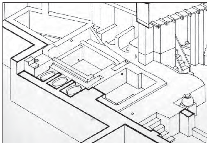
Fig. 4: Représentation isométrique des bassins et des stalles de la fullonica de Stephanus (I 6, 7) (dessin Soprintendenza Archeologica di Pompei , inv. n°P632). Si le premier bassin trapézoïdal n'est qu'une réserve inaccessible aux foulons, il participe néanmoins à la circulation de l'eau en continu. Le volume cumulé des trois bassins est de 9261 litres.
