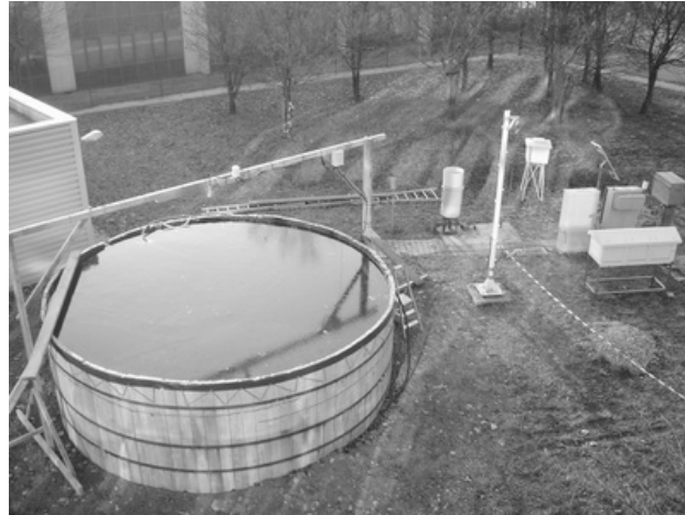
Figure 2 : La piscine d'étalonnage du capteur RC pour l'élaboration de la relation entre l'atténuation du rayonnement cosmique et l'équivalent en eau situé au dessus du capteur.
