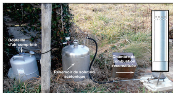
Figure 7 : Exemple de générateur de noyaux glaçogènes type Vortex (la chambre de combustion démontée a été reconstituée schématiquement sur la photo).
