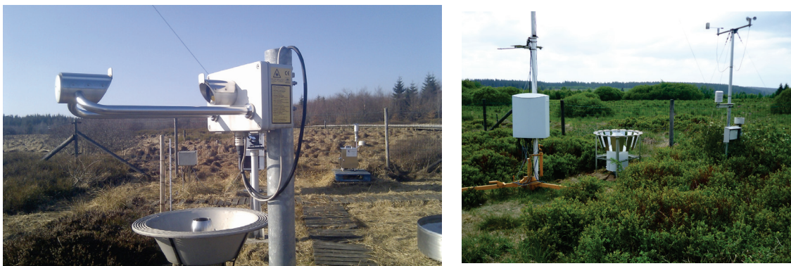
Photos 1a et 1b : Photographies prises au parc météo de la Station Scientifique des Hautes Fagnes (SSHF-ULg) au Mont Rigi (MR), Belgique. Photo de gauche : Disdromètre à laser chauffé (Thies). Au centre de la photo de droite : Pluviographe à pesée (OTT) avec coupe-vent.
