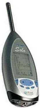
Figure 36. Sonomètre utilisé pour les mesures
