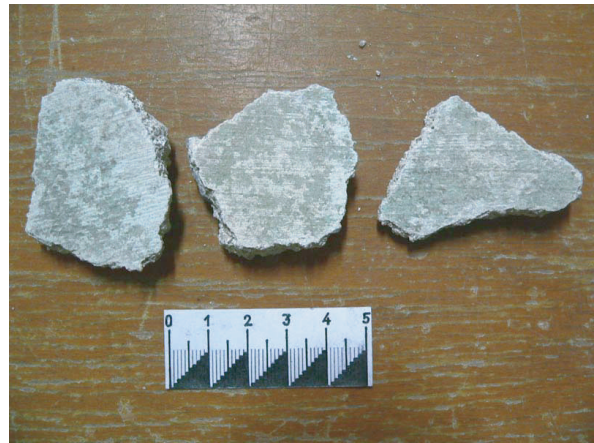
Fig.27 : Fragments d'enduit peint gothique provenant du chevet : couleur verte et traces de brosse liées à l'application de la couleur ? (caisse 87, sac 258, chevet)
