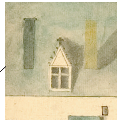
Fig. B : Détail de la lucarne, dont les rampants sont ornés de crochets
