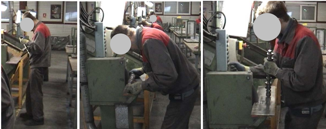
Figure 1 : Opérations d'ébavurage d'un fût de transmission
