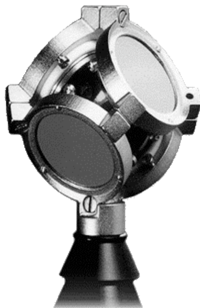
Figure 40 : Montage tétraédrique des quatre capsules du microphone Soundfield Mk V.
