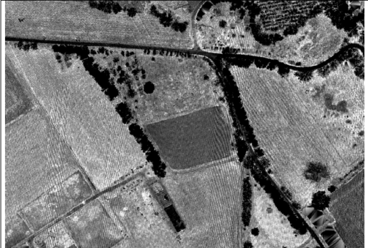
Figure 10 – Image d'intensité des points Lidar au sol avec une résolution de 0.5 m (les zones interpolées où les bâtiments ont été supprimés sont clairement visibles – en bas à droite)
