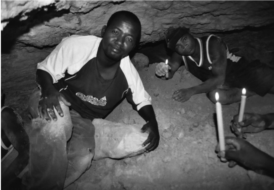
Photo 1 – À Madagascar, comme dans de nombreux pays producteurs de pierres de couleur, l'extraction reste complètement artisanale. Bien qu'étant surmontées de roches extrêmement friables, les galeries ne sont pas étayées, ni ventilées. Les mineurs travaillent courbés dans des tunnels dont la hauteur dépasse rarement un mètre : Carrière d'Analamahavelo, région d'Ilakaka (Sud-Ouest de Madagascar).
