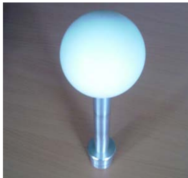
Abb. 5: Zielkugeln mit Vorrichtung zur Zwangszentrierung
