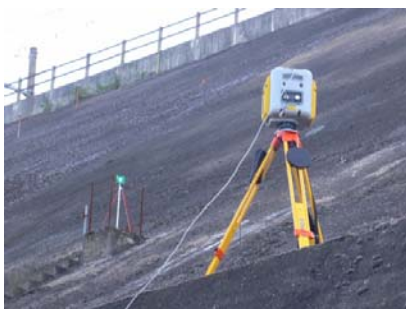
Abb. 9: Trimble GX Scanner bei der Messung eines Referenzpunktes
