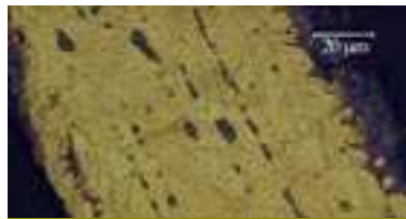
LA COUPE D'UNE PAILLETTE en tôle, vue au microscope, révèle que l'objet a subi des recuits lors de sa mise en forme. Les « chapelets » d'inclusions (en noir) indiquent la direction de la déformation.
