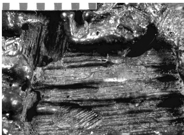
Figure 6 : empreinte de charbon de bois sur le fond d'un creuset luté (L. mire : 1,1 cm).
