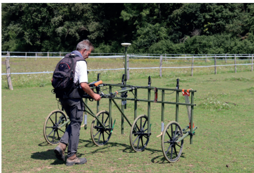
Figure n°6. Système d'acquisition magnétique à 5 sondes (MXPDA – Sensys) poussé devant l'opérateur.
