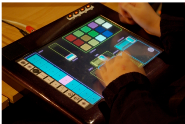
Figure 2. Interface de contrôle des paramètres du dessin. Le choix de la mine se fait sur la partie gauche, les couleurs en haut à droite, et les autres paramètres (transparence, luminosité, taille et rotation de la mine) se trouvent au-dessous.
