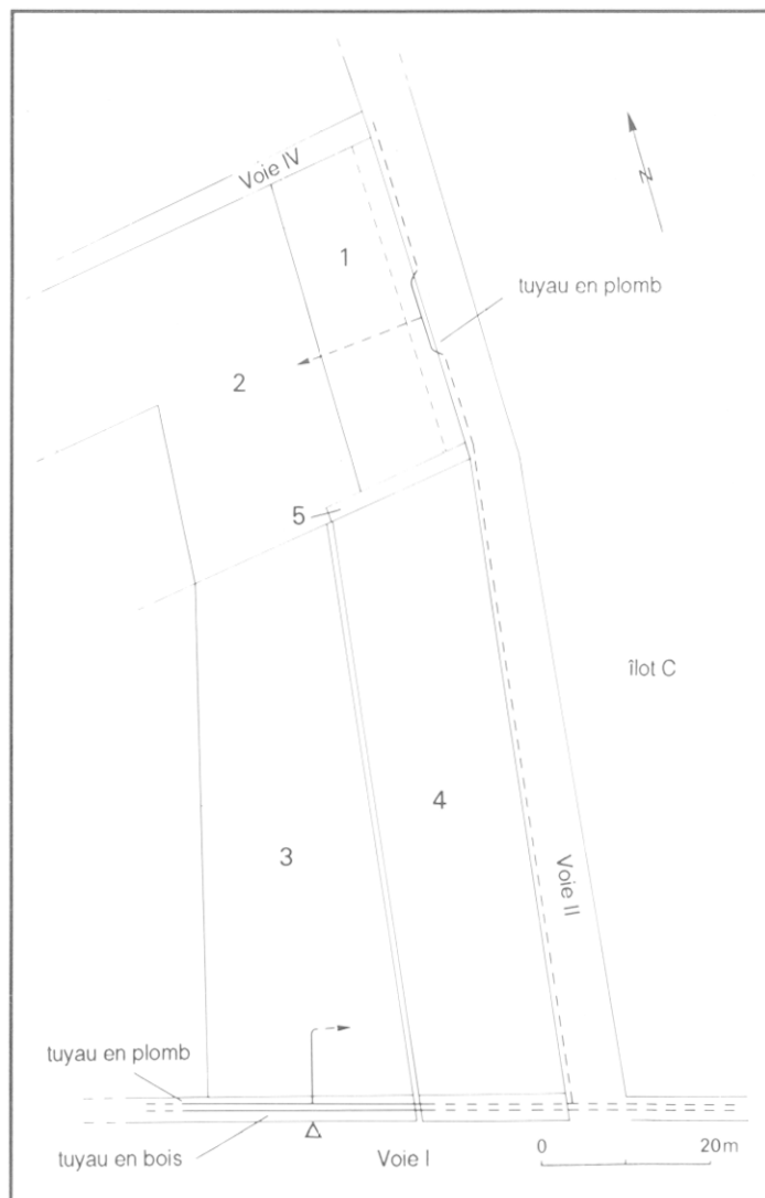
Fig. 26 — Plan du premier réseau d'adduction (état 2A de la Voie II) : 1, zone V, état 2A : Bâtiment Commercial ; 2, zone I : maison au Grand Péristyle ; 3, zone I : maison aux Pierres Dorées ; 4, zone IX : parcelle des Petits Entrepôts ; 5, passage du Bâtiment Commercial ; \Delta : emplacement du sondage I 40 (cf. fig. 25).
